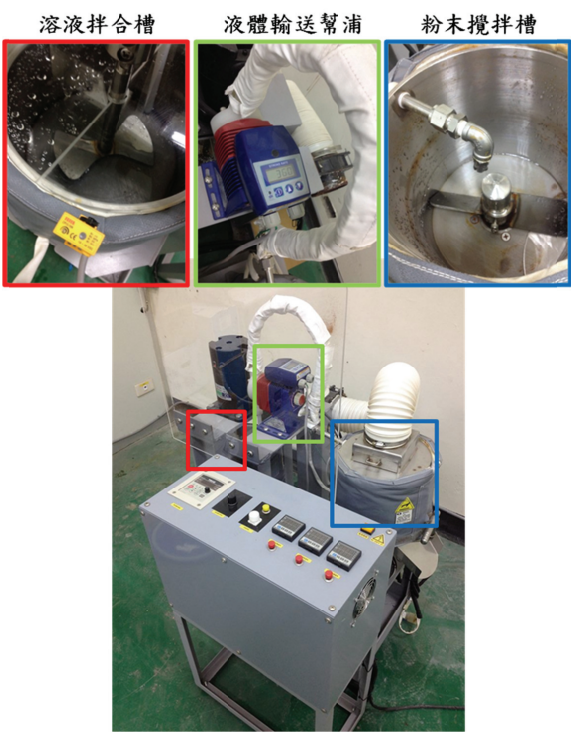
圖3 大規模吸附劑生產機台 資料來源：本研究繪製
