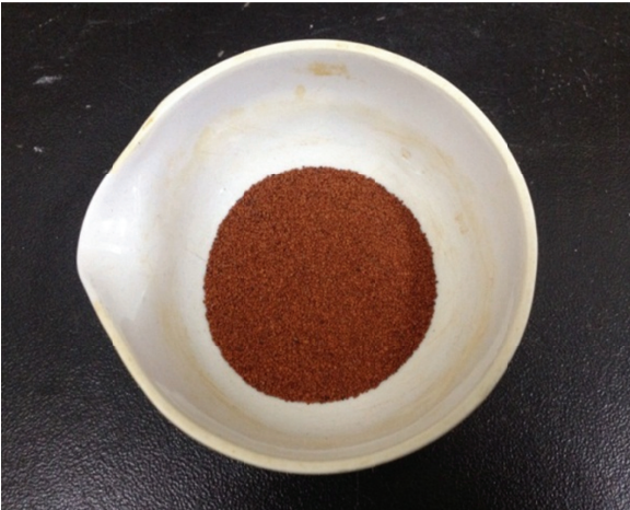
圖2 實驗室規模合成20wt% Fe 2 O 3 /SiO 2 脫硫吸附劑 資料來源：本研究繪製
