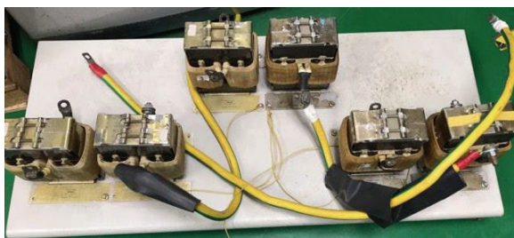
圖15 高頻鐵粉芯電感 資料來源：本研究繪製
