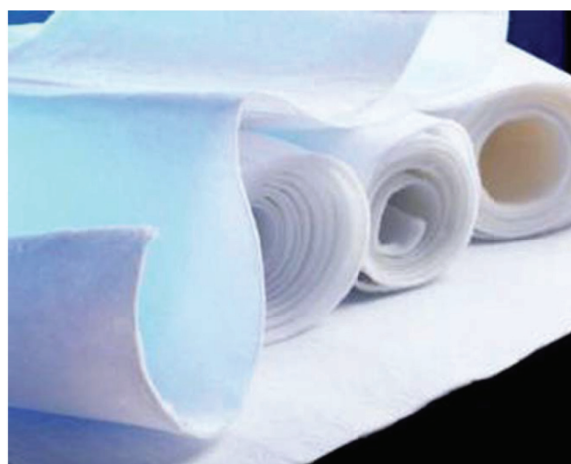
圖12 二氧化矽氣凝膠應用於隔熱建材[4]
