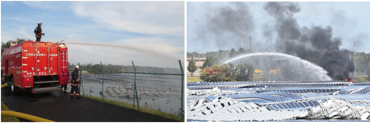
圖10、從距離岸邊最近的北側起火處噴射水柱，使用的是大型水砲消防車(DHCU)。
