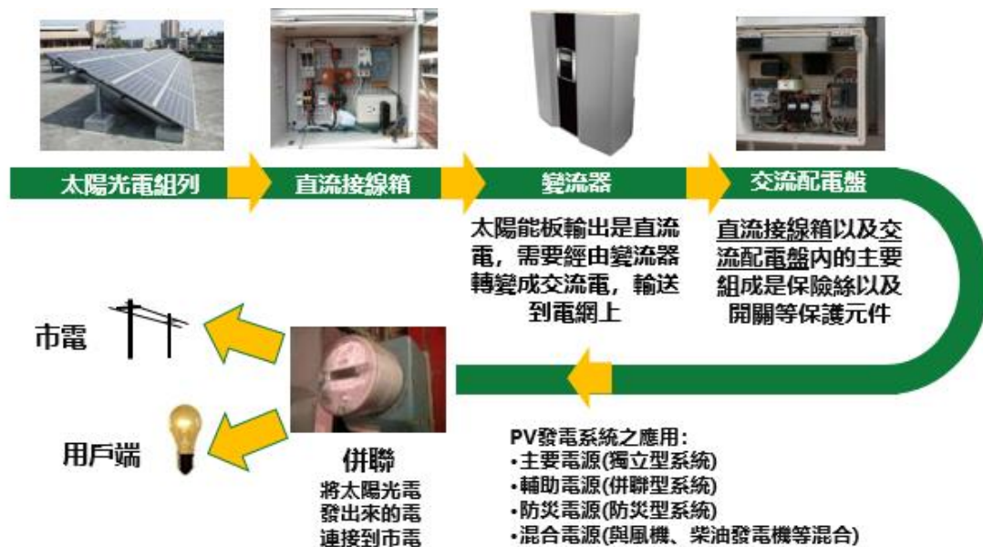
圖 5、太陽光電系統架構示意圖
