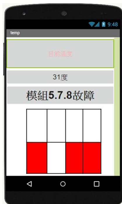
圖 15 太陽光電裝置發電數據異常檢測研究之 APP 顯示畫面規劃
