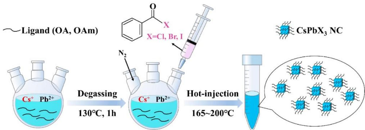
圖 3、熱注射法示意圖[9]
