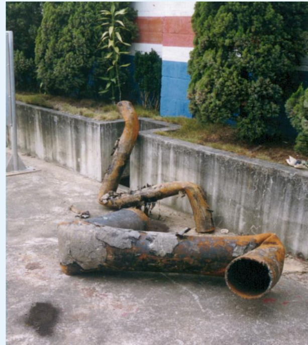
天然氣鋼管在921地震之震損狀況
