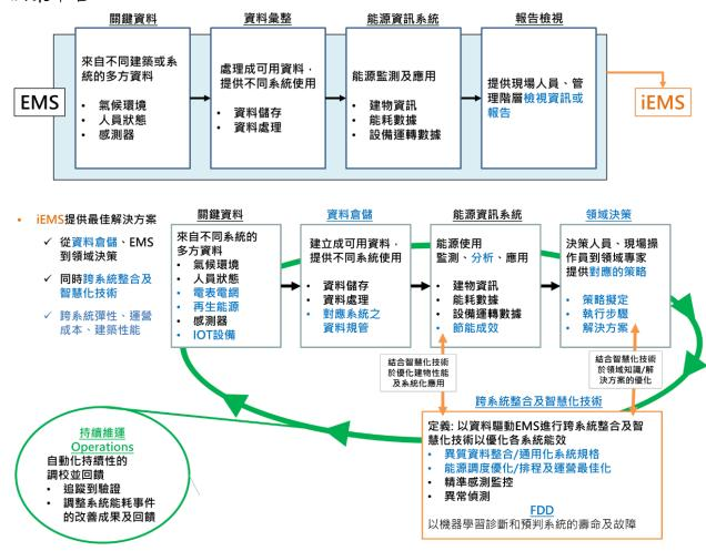
iEMS之主要功能主要可導入資料倉儲概念,整合建物中各系統資訊進 行有效分類,並同步連結各圖控系統,使其能提供上位優化控制決策,最 後針對整體能源成本及建築性能進行分析診斷。其主要功能如下述幾項:
