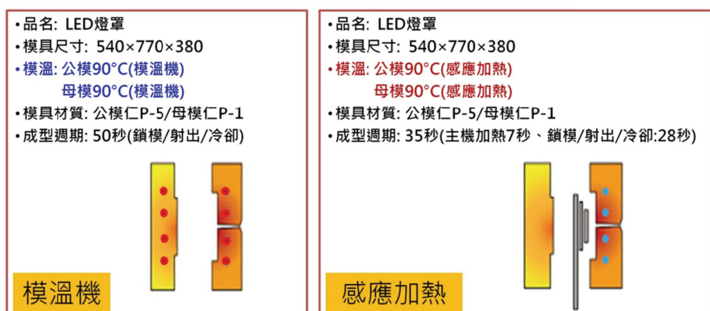
圖1 熱媒式(模溫機)加熱與感應加熱製程參數
