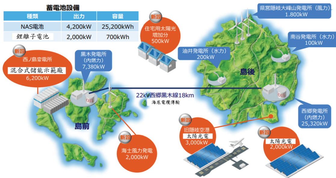
圖23 隱岐群島儲能示範場之擴大再生能源併網配置
