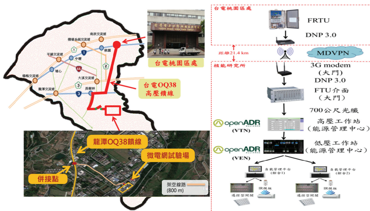
圖9 微電網與台電併接示意圖及調度通訊系統架構(本研究繪製)
