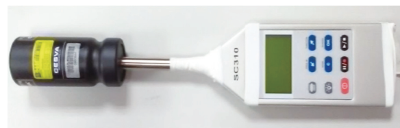
圖9 聲波噪音量測設備與聲音校正裝置(拍攝於核研所)
