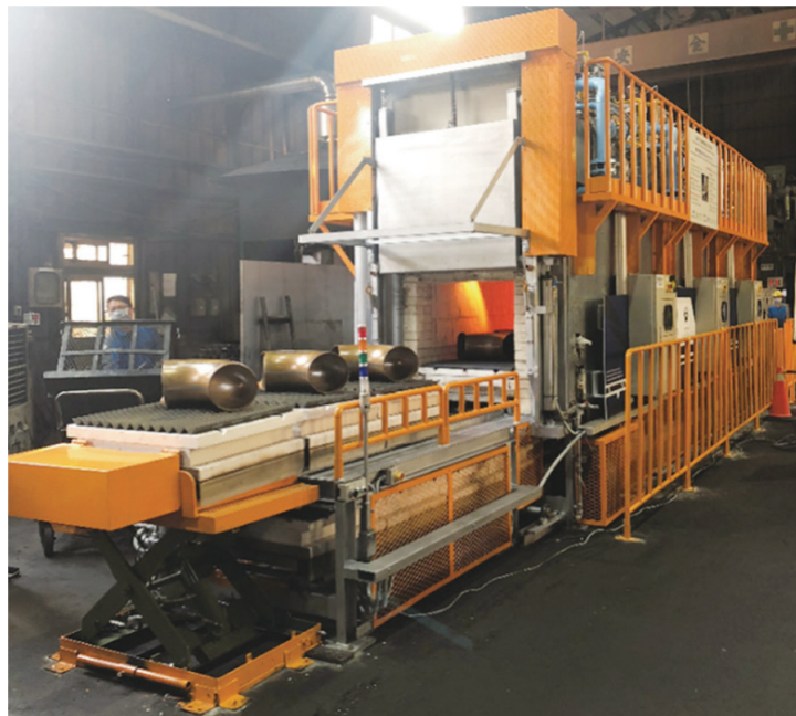
圖2 連續式加熱爐實體示意圖(金屬中心現場爐體圖)
