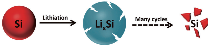
圖2 LIBs純矽負極之矽顆粒崩裂機制(本研究繪製)
