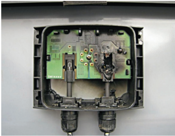
圖2 太陽光電模組濕熱測試腐蝕圖(資料來源：PV magazine, 2013)
