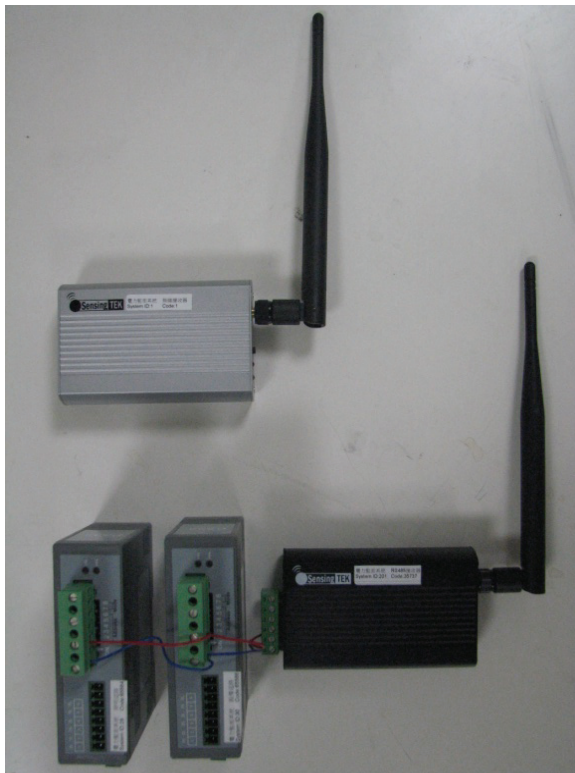
圖5 數位電表及無線傳輸模組配置圖
