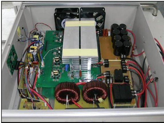
圖7 核研所開發之具平穩切換功能換流器(本研究拍攝)
