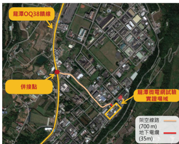
圖18 龍潭微電網實證場域與台電瑞源OQ38饋線併接(本研究繪製)
