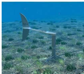
圖3 澳大利亞BioPower公司的振盪水翼式潮流發電機組
