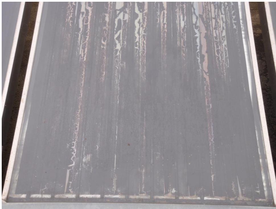
圖一：申請案 9306060 吸收膜脫落情形
