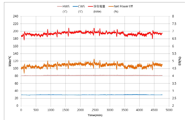
圖5. ORC發電機組溫度與發電量趨勢圖
