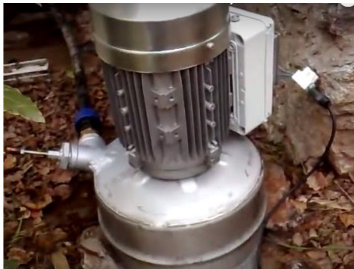
圖三、巴庫拉斯村莊自製微型水力發電機
