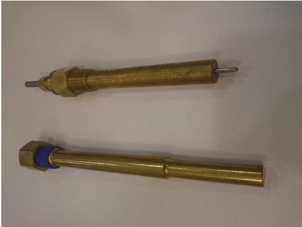
圖1、親水式溫度計（上方）與套筒式溫度計（下方）比較圖
