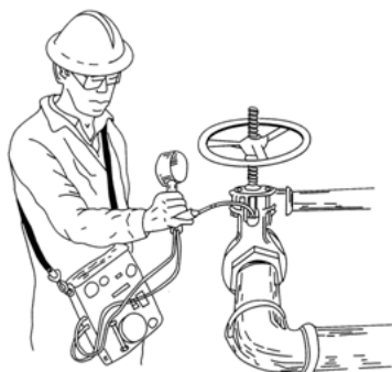
圖 1 傳統檢測元件氣體洩漏的方式需靠近洩漏處並逐一檢測
