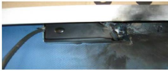
圖八、焊接不良引起電弧發生
