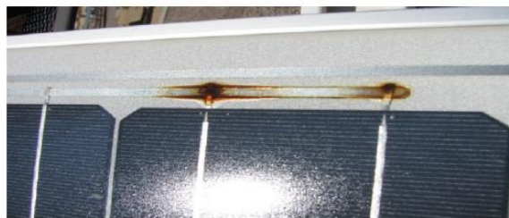
圖七、同片電池片中，兩條連接帶與焊料產生電阻加熱
