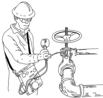
圖 5 傳統檢測元件氣體洩漏的方式需靠近洩漏處並逐一檢測
