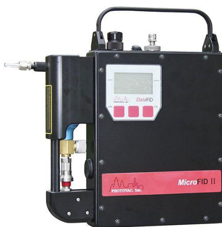
圖 13 可攜式火焰離子化偵測器外觀
