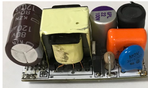
圖1. 本計畫燈管內藏式電源供應器雛型
