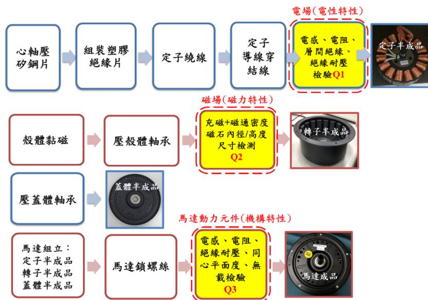
圖4、外轉子永磁無刷馬達之半自動化生產作業流程
