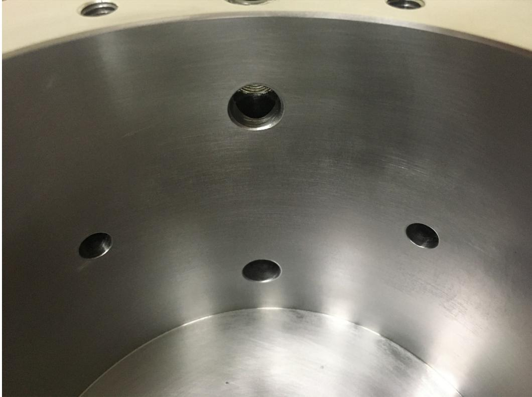
圖16、軸殼上設計有相對應的入油孔及出油孔，並對其導0.5mm的圓角。
