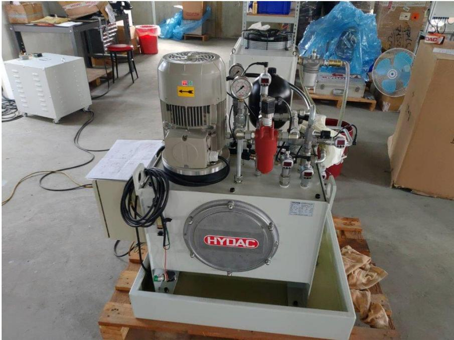
圖17、靜動壓軸承跑合測試用供油系統
