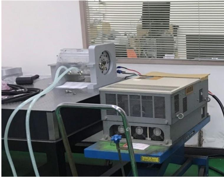
圖 20、跑合測試台的變頻驅動器與馬達配置。
