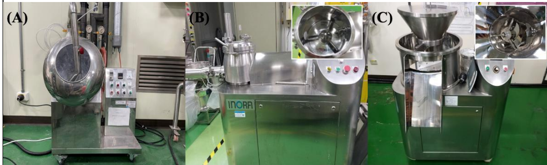
圖 1、本計畫開發之三種造粒技術平台：(A)滾動造粒、(B)混合-離心圓球造粒、(C)擠出-離心圓球造粒
