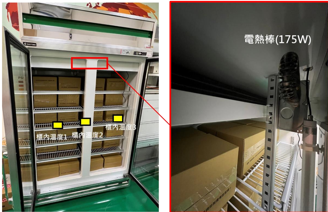
圖 4、外氣入侵量量測實驗
