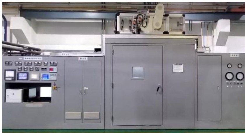
圖 12、壓縮機性能測試平台整體照
