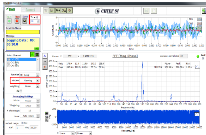
圖2、振動測試軟體設定示意圖
