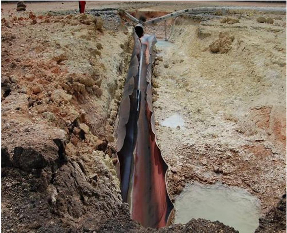
圖 3、Enterprise 公司天然氣管線爆裂開的片段，約有 100 英尺長
