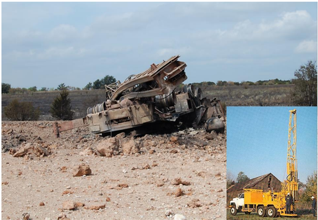
圖 4、C&H 公司 60 噸的鑽洞卡車被翻轉過來，右下角圖所顯示的是同型的鑽洞
