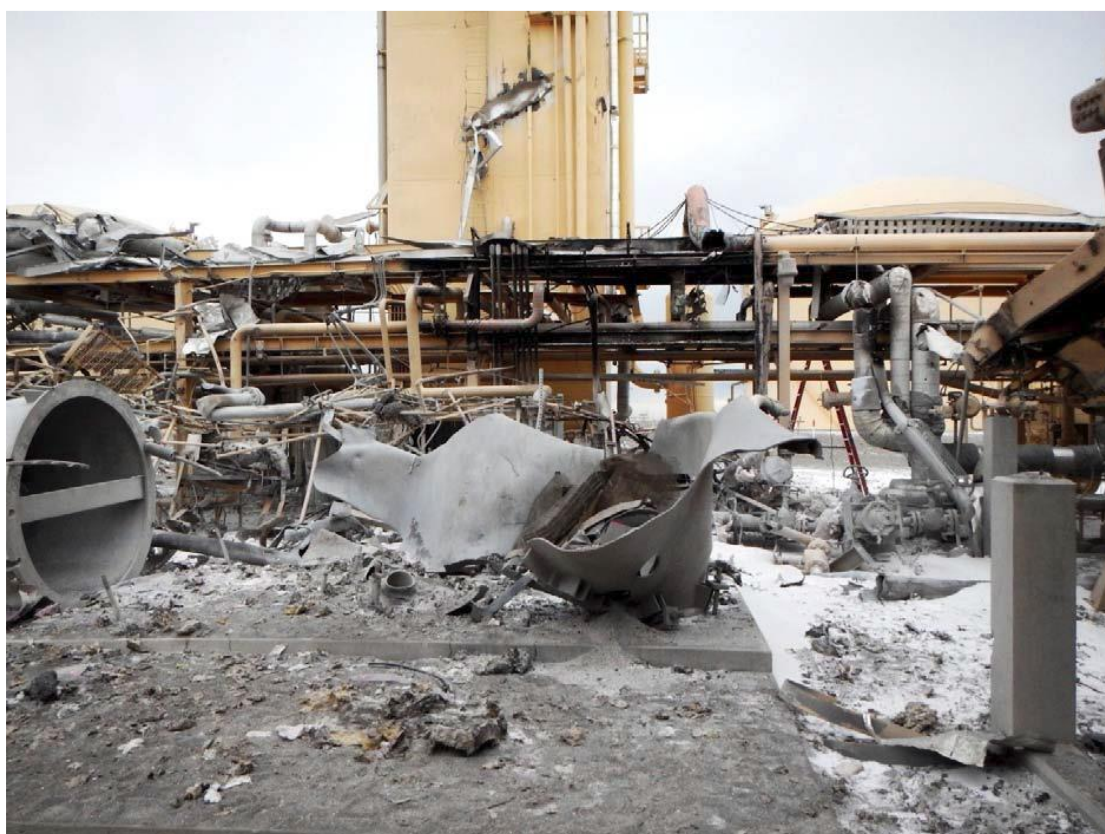
圖 11、失效的吸附器基地中心的殘餘物。冷凍塔頂中心。來自失效的吸附器的大塊碎片嵌入塔的中心
