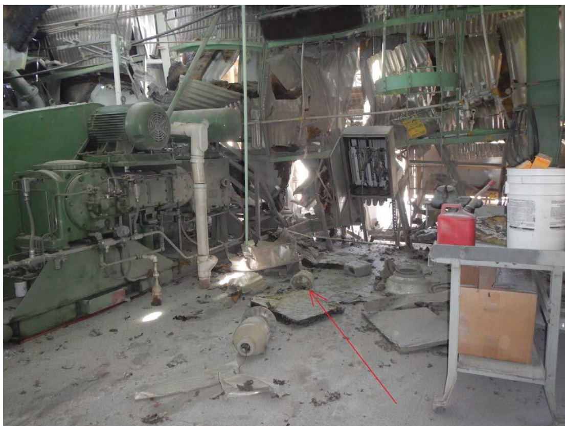
圖 7、壓縮機大樓內部情形，其中 2 名員工正在監聽壓縮機啟動。在照片中，故障的吸附器位於後牆外側。因燒傷而住院的員工就在這個區域。紅色箭頭指的是一頂安全帽。
