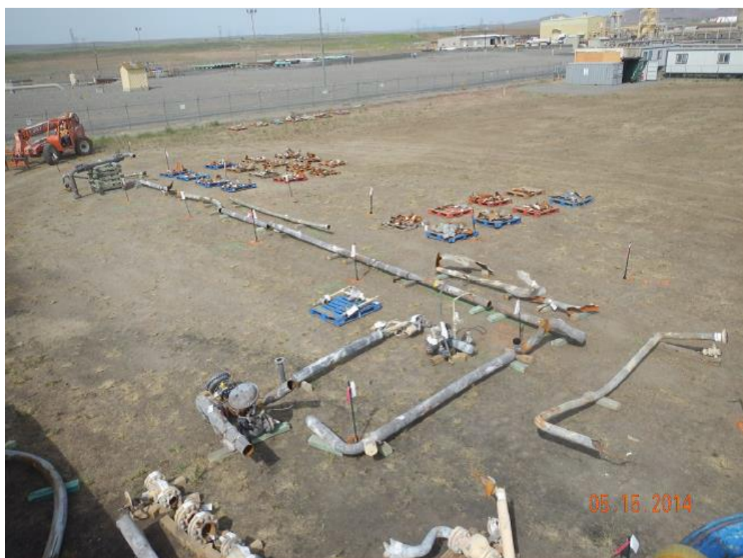
圖 17、失效的管線重新組裝在安全的證據場中，盡可能靠近原始管線配置。標樁(stake)放置在管架橫樑上。仔細觀察發現，由於“滾動爆炸(rolling detonation)”導致管道內部發生許多故障。4 英吋鹽浴加熱器進氣管放置在鹽浴加熱器 6 英吋出口管線旁。托盤裝有 4 英吋管的所有小碎片。
