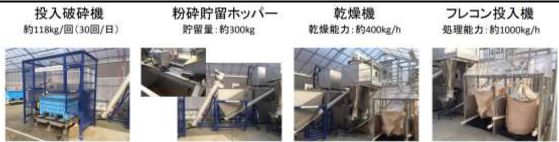
圖 3 廢棄太空包轉製生質燃料設備[4]
