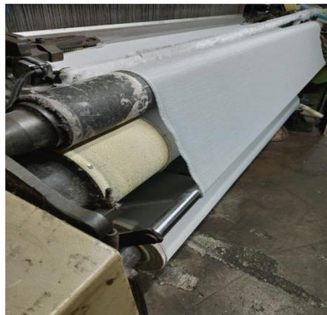
圖 4：遮陽金屬短纖混紡紗織物織造
