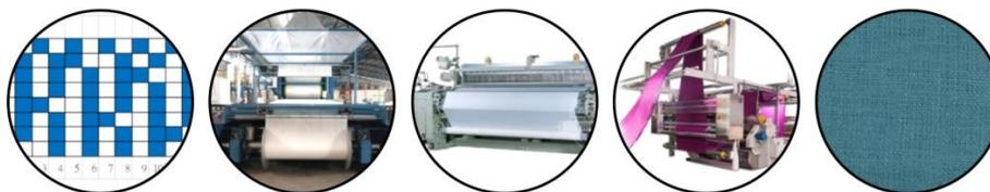
組織設計→漿紗/整經工程→織造工程→染整/定型工程→成品布
