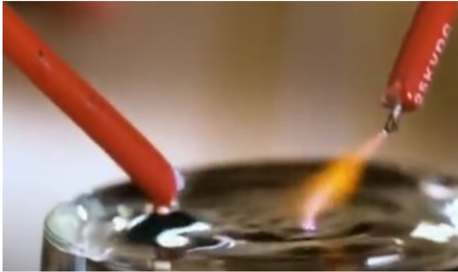
圖 4、高壓電遇水的電弧效應[5]
