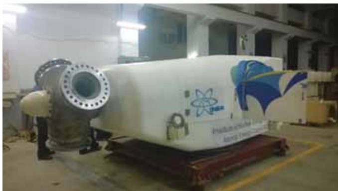
(a) 水平軸風力發電機系統之機艙結構
