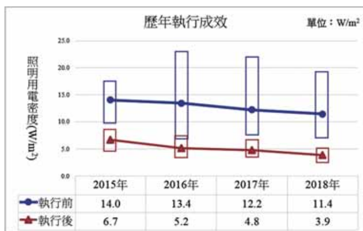
圖6 LED室內智慧照明示範計畫LPD變化趨勢 註：2018年度為計畫書預估值 資料來源：本研究整理。
